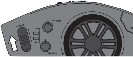
2. Verbinden Sie den Fahrakku mit dem Regler und schalten den Regler ein.
