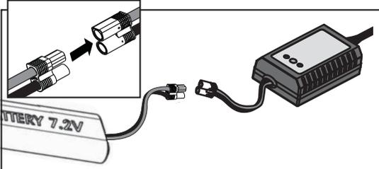
Das Ladegerät lädt mit 2,0A (2000 mAh) per Stunde. Dividieren Sie die auf dem Akkuetikett angegebene mAh Kapazität durch 2000 um die erforderliche Ladezeit zu errechnen. So benötigt zum Beispiel ein 1800mAh Akku 0,9 Stunden = 54 Minuten zum laden.
