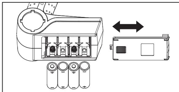
Wir empfehlen AA Alkaline Batterien in dem Sender zu verwenden. Sie können auch wiederaufladbare NiMH Akkus verwenden.
